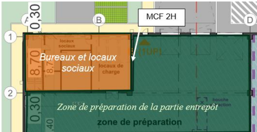
Exemple des locaux sociaux et du local de charge de la cellule A1 (plan RDC disponible en annexe n°1)
